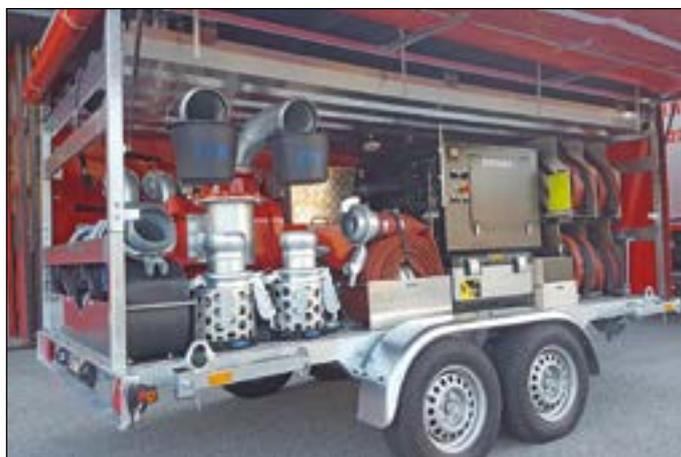
Pumpe hat eine maximale Leistung von ca 5500 Liter pro Minute und weist eine Druckhöhe von 34 m auf. Auf dem Anhänger sind noch 23 m F-Saugschläuche, 300 m F-Druckschläuche, Übergangsstücke, Beleuchtung, Werkzeuge usw. verstaut.
